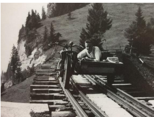
Töf-Motorenwagen von Josef Dahinen und einem Opel-Schienen-Auto auf dem stillgelegten Bahntrasse Kaltbad – Rigi Scheidegg
